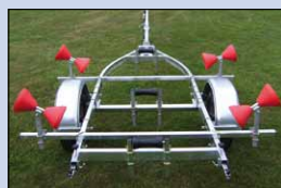
Uitgevoerd met trompetrollen
